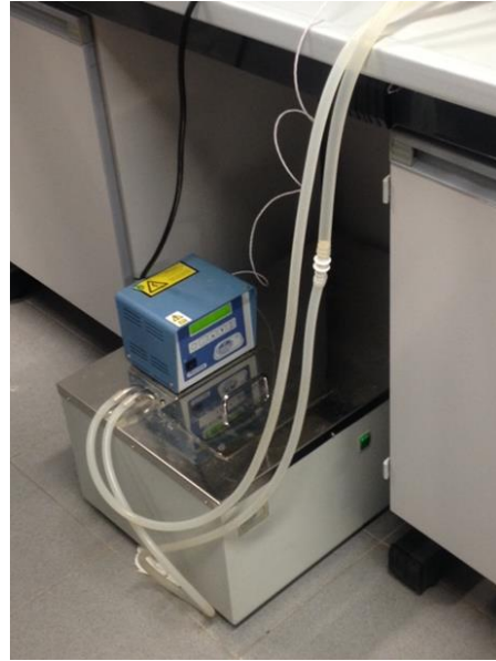
Baño termostático, con termostato, se recircula el agua
