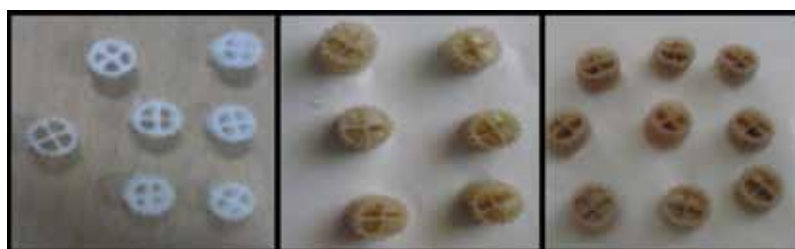
Figura 3. Relleno del tanque aerobio: día de operación 0, 23 y 50 (de izquierda a derecha).
